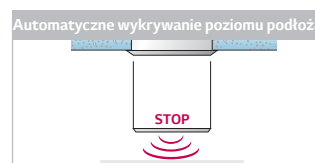
Automatyczne wykrywanie poziomu podłoża
