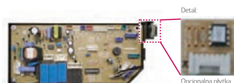
(Główna płyta PCB zestawu kontrolnego)
