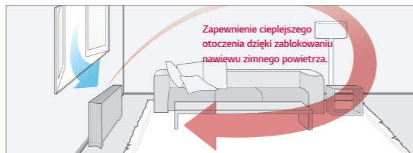
Zainstalowany klimatyzator podłogowy
