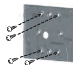
<montaż 4 gniazdowego elementu kompensacyjnego>
